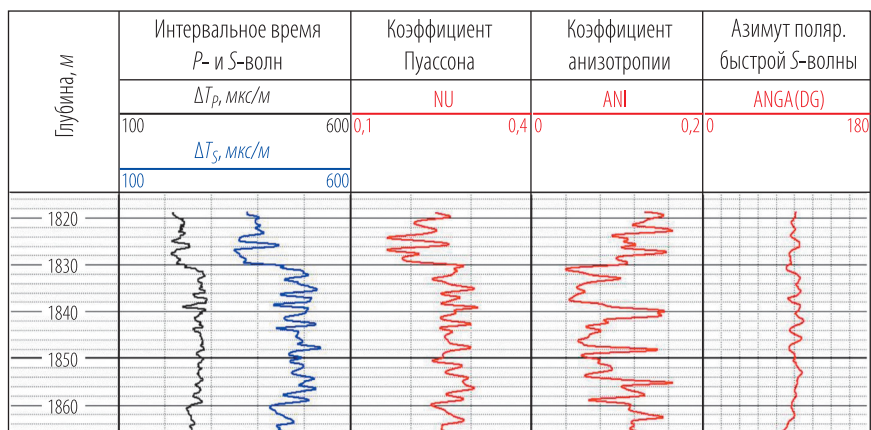
Рис. 5. Планшет материалов АВАК в горизонтальной скважине. Стабильное значение угла анизотропии указывает на влияние несбалансированного горного давления как на причину азимутальной анизотропии в горных породах
