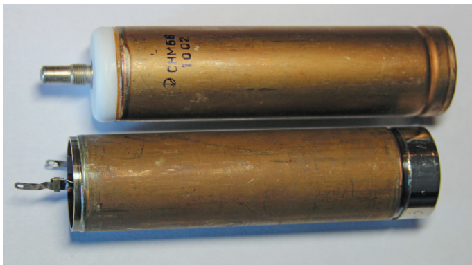
Рис. 1. Внешний вид счетчиков CHM 56 (вверху) и CHM 56M (внизу)
