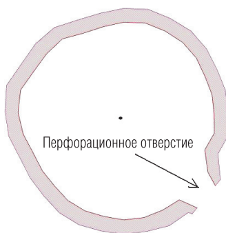
Рис. 6. Поперечное сечение обсадной колонны в интервале кумулятивной перфорации на глубине 2582,4 м. Построено по данным сканера (30 волновых картин на один оборот головки)
