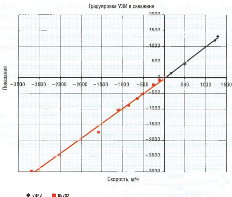
Рис. 2. Градуировочная характеристика ультразвукового расходомера, полученная в скважине при разных скоростях движения прибора
