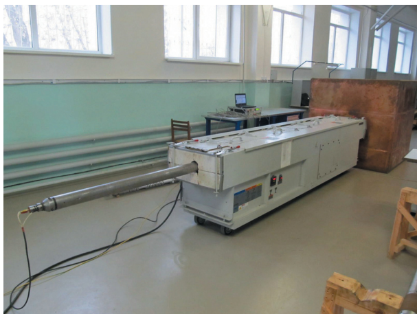
Рис. 2. Прибор в процессе прогрева. Используется одна секция печи
